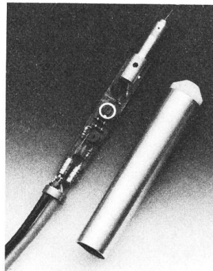
Fig. 12 Construction de la sonde
