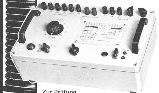
Zur Prüfung von einphasigen Maximal- und Minimal-Spannungs-Relais, Maximalstrom-Relais und Differentialschutz-Kreisen.
