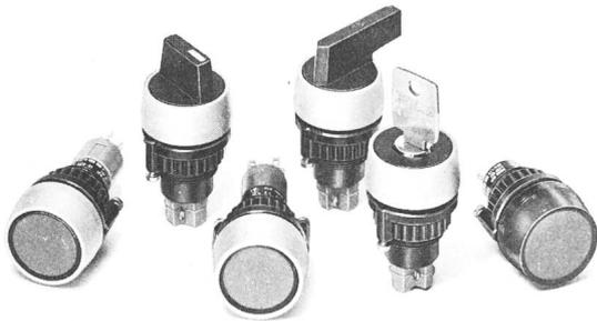
La série 14 de EAO se distingue: de la haute précision en service dans des mauvaises conditions d'environnement. Partie frontale, robuste à vocation industrielle, étanche à l'eau et aux huiles (IP67) combinée avec les fameux systèmes de commutation bénéficiant d'une longue maturité technique pour puissances moyennes et petites (quelques  $\mu\text{V}/\mu\text{A}$  à 250 V/5A).
