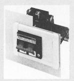
24 und 184 mm wird ausgespart, die beiden Befestigungslöcher werden gebohrt und der Frontrahmen kann, auch nachträglich, einfach montiert werden. Alsdann werden die gewünschten Einbau-Apparate auf Normschienen aufgeschnappt und befestigt. Insbesondere für Leitungsschutzschalter, Fehlerstrom- und Motorschutzschalter usw.
