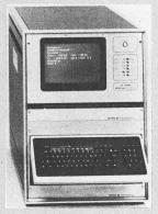
häuse und besteht aus dem eigentlichen Brückenteil, dem Mikrocomputer, dem Bildschirm mit Tastatur (die herausgeklappt werden kann). In Dialogtechnik werden die Grössen des Vergleichsnormales, des Prüflings usw. eingegeben. Die Messung erfolgt vollautomatisch, und es bestehen zusätzliche Optionen für eine Fernsteuerung, für den Datenaustausch, den Anschluss eines Druckers usw.
