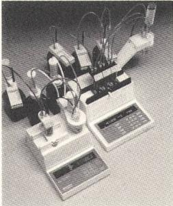
**Moderne, mikroprozessorgesteuerte Instrumente automatisieren chemische Analysen – hier die Titration in der Nasschemie**
