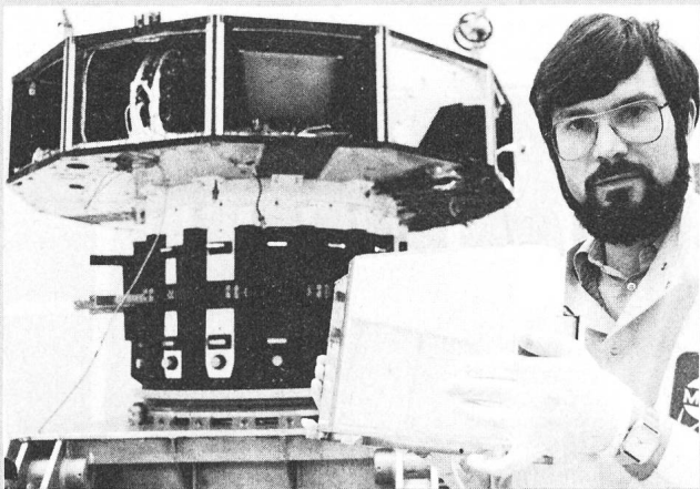
Sensor mit Silizium-Messdetektoren; im Hintergrund halbfertiger Satellit
