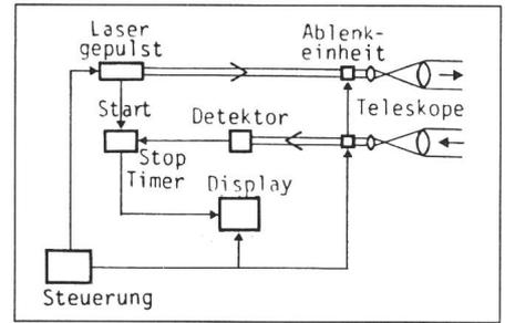
Fig. 7 Aufbau eines Ladars mit direkter Detektion
