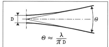
Fig. 8 Zusammenhang zwischen Strahldurchmesser und Divergenz
