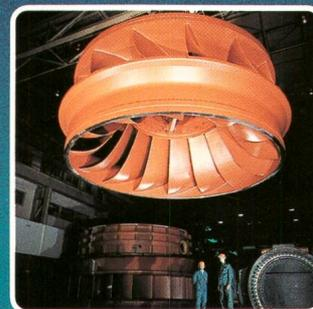
Eine von 6 **Francisturbinen** mit 340 000 kW Einheitsleistung für das Kraftwerk Karakaya (Türkei).
