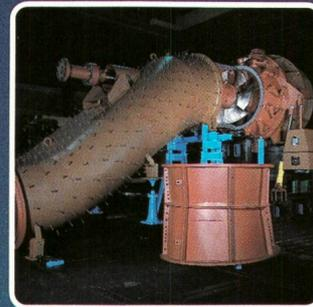
**Standardisierte S-Turbine** für 3130 kW bei 22,7 m Fallhöhe (Fourth Lake, CDN), im Werk Bell, Kriens.
