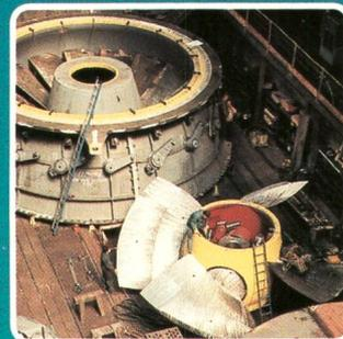
Grösste **Rohr-turbinen** der Welt für das Kraftwerk Racine (USA).
