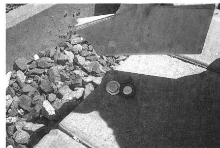
Fig. 9 Stromflussspuren auf einer der Kontrollfunktstrecken
