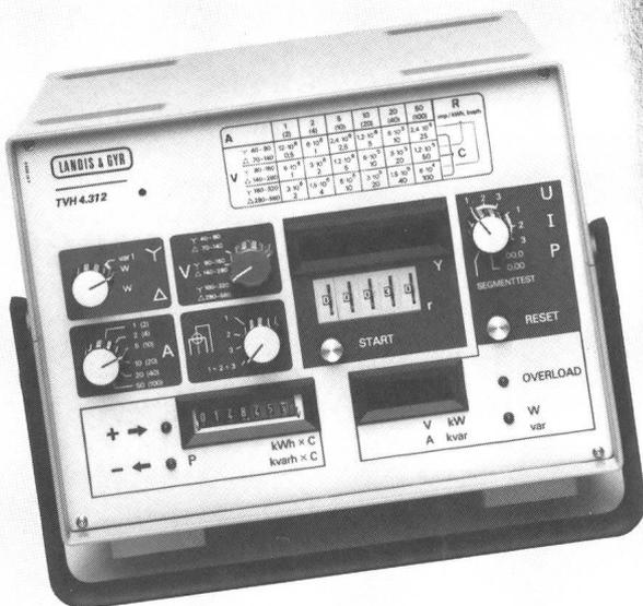
Die universelle Zählerprüfeinrichtung von hoher Genauigkeit. Eine Spezial-Entwicklung von Landis & Gyr.
