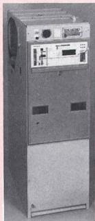
Das Schaltfeld Vercors M6 ist für Nennspannung 24 kV, Nennstrom 400 bzw. 630 A, Kurzschlussstrom 12,5-16 kA eff. sowie mechanische Lebensdauer von 5000 Schaltspielen bestimmt. (Merlin Gerin AG, 1202 Genève)
