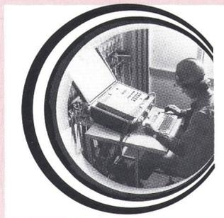
zur Messung des gesamten Netzes. Typ MIC 11 (Fig.) ist zur Messung von Hochleistungsnetzen bestimmt, mit Kurzschlussströmen bis zu 80 kA. Ein tragbarer Klein-Computer ermöglicht die Erstellung eines Messprotokolls. Der EGPE-Hochleistungs-Entlader für Mittelspannungsnetze dient dem Schutz gegen Blitz für die Leitungen, die Blitzableiter und die Transformatoren. Für thermische Messungen eignen sich
