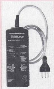
ner wird kontrolliert, ob Schutz- und Aussenleiter vertauscht oder miteinander verbunden sind, der Schutzleiter richtig angeschlossen oder unterbrochen ist, ob nicht eine Unterbrechung des Aussenleiters und/oder Neutralleiters vorliegt. Gleichzeitig prüft das Gerät, ob nicht der Aussenleiter (Phase) mit dem Neutralleiter (Nulleiter) vertauscht ist. Die Messergebnisse werden durch Leuchtdioden angezeigt.
