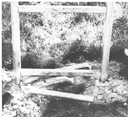
Fig. 6 Die Leiter stand in Kontakt mit einer Freileitung. Drei Sprossen sind abgebrannt
