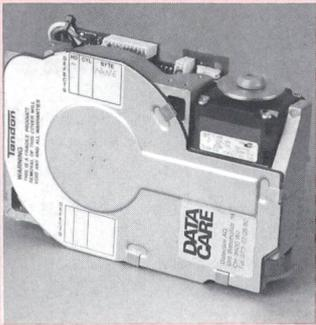
3 1/2 Zoll-Winchester-Drive mit dem ST 412/506 Interface. Der Drive besitzt 4 Hard Coated Plated Media - Oberflächen mit einer Spurdichte von 804 TPI. Die Anzahl Zylinder ist 615, und die formatierte Kapazität beträgt 20 MByte. Die Köpfe werden durch einen Pseudo-Closed-Loop-Servo mit einer durchschnittlichen Zugriffszeit von 80 ms. positioniert. Die Stromaufnahme beträgt 14 W.
