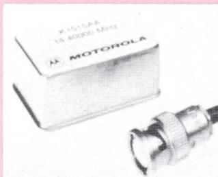
Die Frequenzstabilität erreicht bis zu  $\pm 1$  ppM zwischen  $-30$  und  $+90$  °C. In diesem Wert sind auch Schwankungen der Umgebungstemperatur, Betriebsspannung, Last und Luftfeuchtigkeit enthalten. Die Alterung erreicht einen Wert von 1 ppM/Jahr im Maximum. Mittels eines Potentiometers oder mit einer Regelspannung können die Oszillatoren abgeglichen werden. Es sind auch
