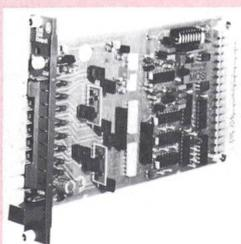
oder zur Schrittmotoransteuerung, wird die 24-V-DC-Ausgabebaugruppe EBE 256 eingesetzt. Bei einem Gleichzeitigkeitsfaktor 1 ist jede Stufe mit max. 420 mA bei 24 V DC belastbar. Bei 50% ED sind 2100 Schaltungen pro h ( $I_e = 420$  mA, Zeitkonst.  $T = 50$  ms) bzw. 18 000 ( $I_e = 20$  mA,  $T = 15$  ms) erreichbar.
