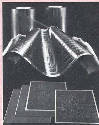
«Riston» 3813 wird in einer 1%igen Natriumcarbonat-Lösung bei 30 °C entwickelt und anschliessend in einer 1 bis 1,5%igen Kalilauge (KOH) bei 50...85 °C gestriipt. Der Film wird in einer Stärke von 32 Micron hergestellt und ist in allen gebräuchlichen Breiten ab Lager lieferbar.
