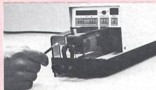
Der Hauptvorteil des Automaten liegt in seiner Programmierbarkeit. Die Abmessungen von 39 Kabeltypen sind vorprogrammierbar. Beim Wechsel von einem Kabeltyp auf den anderen braucht nur ein Vorschaltwähler verstellt zu werden. Die Abisoliermesser müssen dabei nicht gewechselt werden. Das Gerät arbeitet ohne Druckluft. (Ernst Hess + Cie, 4006 Basel)
