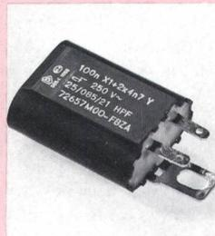
Störschutzkombination X1Y mit einer direkt an die Geräte- masse anschliessbaren Befestigungsglasche. Für die beiden Netzanschlüsse der X1-Kapazität stehen wahlweise Faston-kompatible Steckzungen 2,8x0,5 oder flexible, isolierte Litzen zur Auswahl. Auf Anfrage auch mit kundenspezifischen Anschlüssen lieferbar. Litzen-
