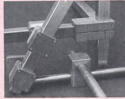
tik in der Konstruktion vereinbaren. Anstelle von Schweißnähten treten flexible Rohrverbinder. Im Maschinenbau findet das Blockelement seine geeignete Verbreitung.
