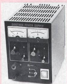
Die Ausgangsspannung zwischen 0,1 und 3 VDC sowie der Ausgangsstrom zwischen 0,1 und 4 A können mittels Potentiometern grob und fein eingestellt werden. Eine LED zeigt das Ansprechen der Strombegrenzung an. Das Netzgerät ist kurzschlussfest; ein thermischer Überlastschutz schaltet dieses bei Überschreiten der zulässigen Temperatur vorübergehend ab.
