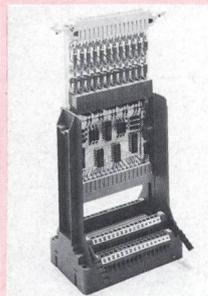
Das Gehäuse besteht aus glasfaserverstärktem Polyamid, so dass die Printkarte in allen Richtungen gut abgestützt ist. Die Befestigung geschieht mit 2 bzw. 4 Schrauben auf jeder Unterlage. Zwei Verriegelungsklinken sichern den Print gegen Herausrütteln und übernehmen die Zusatzfunktion der Auswerfhilfe. Der Leiteranschluss beträgt 2,5 mm<sup>2</sup> feinstdrähtig. Die Nennspannung wird bestimmt durch die Geometrie der Steckerleisten.
