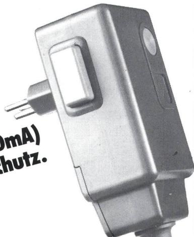
Eine integrierte Elektronik erkennt sofort Fehlersituationen wie Fehlerstrom, gegen Erde, Unter-, Null- oder Überspannung, Leiterbruch etc. und trennt in weniger als 30 mS die Kontakte allpolig vom Netz, so dass keine lebensgefährlichen Unfälle entstehen.
