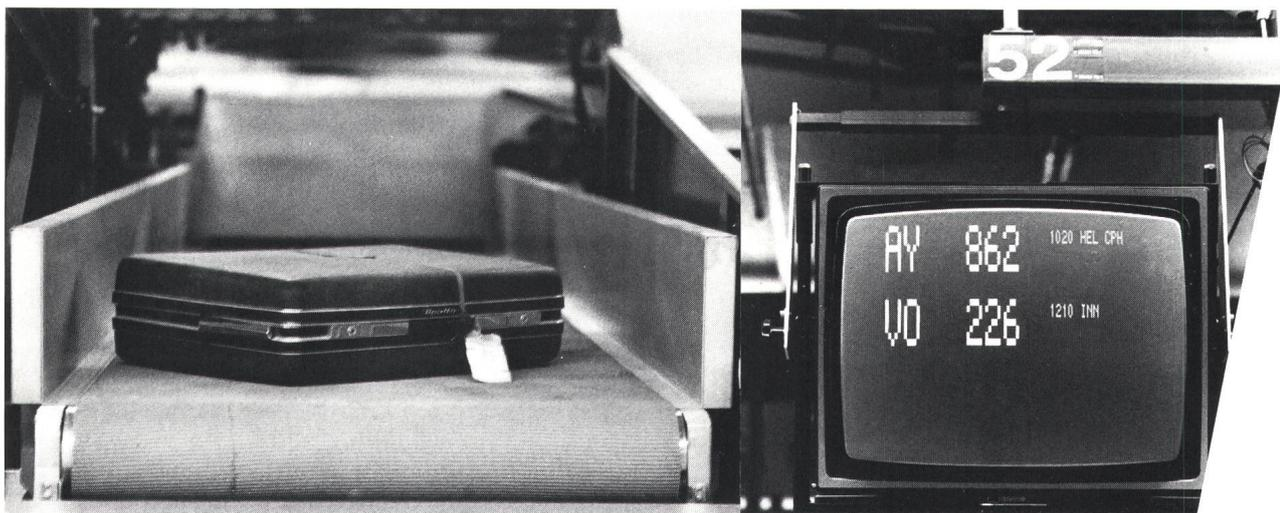
*Flughafen Kloten, Terminal A. Die neue Gepäcksortieranlage ist eine der modernsten der Welt. Ein brillantes Grundkonzept mit 8 Computern, 8 frei-programmierbaren Steuerungen, 2500 m Förderbändern und 600 Motoren von insgesamt 750 kW sorgt für eine hervorragende Leistung.*
