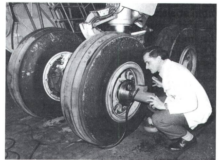
Fig. 5 Zustandskontrolle am Hauptfahrwerk der A 310
