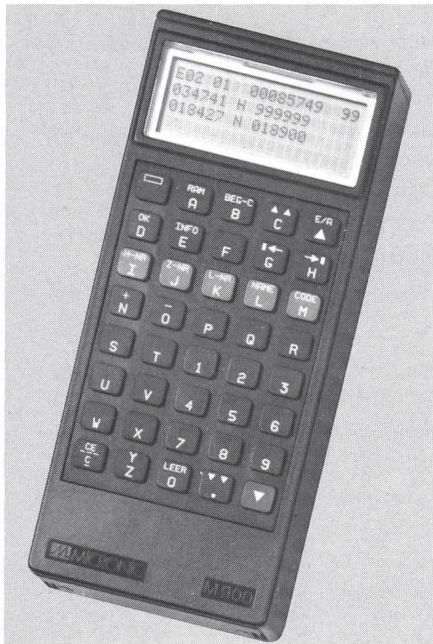
Fig. 1 Micronic 940, ein Handterminal der 2. Generation, Display 4x20 Stellen, RAM bis 576 kB, 200x90x38 mm, 550 g
