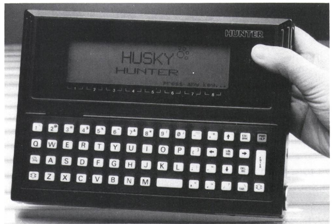
Fig. 2 Wasserdichter Handheld-Computer HUSKY Hunter, RAM bis 496 kB, Anzeige max. 8 Zeilen à 40 Zeichen, in Basic programmierbar. Flächenausmass A5, 1,2 kg (Beispiel)
