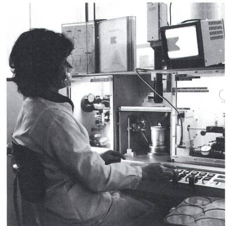
Fig. 6 Herstellung der doppelpositiven Randkontur an Hochspannungsthyristoren durch Sandstrahlen
