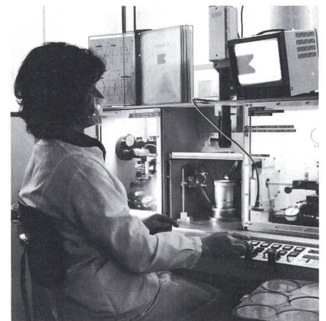
Fig. 6 Herstellung der doppelpositiven Randkontur an Hochspannungthyristoren durch Sandstrahlen
