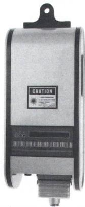
Für Kontroll- und Servicezwecke ist im Gerät ein 20stelliges LCD-Fenster zur Anzeige der gelesenen Codes integriert.
