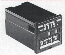
nuell eingestellt. Auf dem vierstelligen Display wird die abgelaufene Zeit kontinuierlich angezeigt. Das DIN-Gehäuse für Fronteinbau misst 48x48 mm. Betriebsspannungen 24 VDC bis 220 VAC. Mit dem potentialfreien Arbeits- bzw. Ruhekontakt können Leistungen von 1 mW bis 2 kW geschaltet werden.
