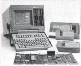
Die Knotenaktivitäten können von einem der zum Funktionstester GR 2620 erhältlichen Module erzeugt werden:
