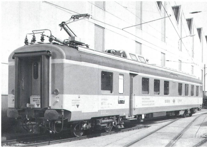
Figure 1 Voiture de mesure des lignes de contact
