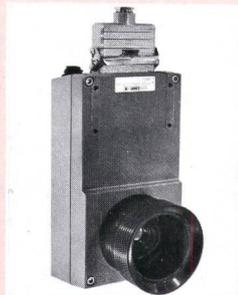
Die Auswahl von neuester Technologie gepaart mit einer geeigneten Wahl der elektronischen Schaltung, gibt der Lesekamera eine hohe Empfindlichkeit und eine gute Auflösung für geringe Strichbreiten bei kompakter Bauform und geringem Gewicht. Die gelesene Information des Strichcodes wird decodiert und die Daten über eine serielle Schnittstelle (RS 232, CL 20mA, RS 422) dem Computer zur Verfügung gestellt.
