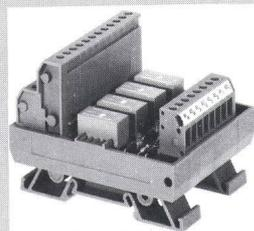
den DIL-14-Sockel. Dies hat den grossen Vorteil, dass bei Servicearbeiten nur das Relais und nicht das ganze Modul ausgewechselt werden muss. Alle Relais sind zudem mit einem Verpolungsschutz und einer optischen Betriebsanzeige versehen. Die vorhandenen Leuchtdioden informieren bei Routinekontrollen oder Fehlersuche sicher und schnell über die Schaltzustände der einzelnen Relais. Um keine unerwünschten Rückwirkungen ins Netz zu verursachen, ist parallel zu jeder Spule eine Freilaufdiode ge-
