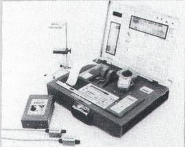
bräuchlichen Energien. Das Gerät ist einfach und ohne Eingriffe in die vorhandenen Energieverteilungssysteme an das zu untersuchende Netz anzuschließen. Der Analysator liefert exakte Protokolle und aussagefähige, grafische Verbrauchsprofile über Elektro-, Gas-, Öl-, Wasser- oder Wärmeverbrauch. Er dient zur Beurteilung der Energiekosten, zur Aufdeckung von Verbrauchsspitzen und zur Empfehlung von kostensenkenden Massnahmen.
