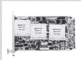
Die Eingangsimpedanz der Trennwandler beträgt 200  $\Omega$ . Bei maximalem Eingangsstrom von 20 mA beträgt der Spannungsabfall 4 V. Die maximale Eingangsspannung kann jedoch 35 V betragen.
