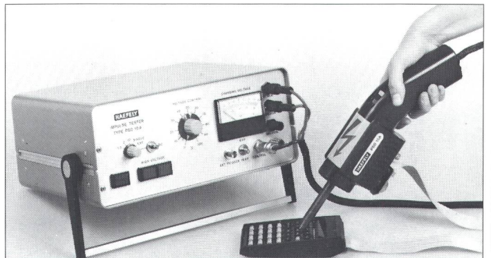
Type PSD 15 A für die Simulation von Entladungen statischer Energie bis 15 kV, nach IEC 801-2; Typ RSD 25 A bis 25 kV
