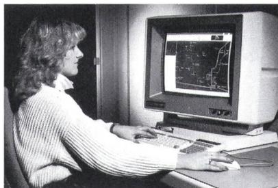
**Das Verteilnetzführungssystem TELEGYR® VNS 1500 ist ein rechnerunterstütztes, graphisches Informations-, Führungs- und Dokumentationssystem für elektrische Verteilnetze. Es informiert den Anwender jederzeit und rasch über den aktuellen Netzstatus.**
