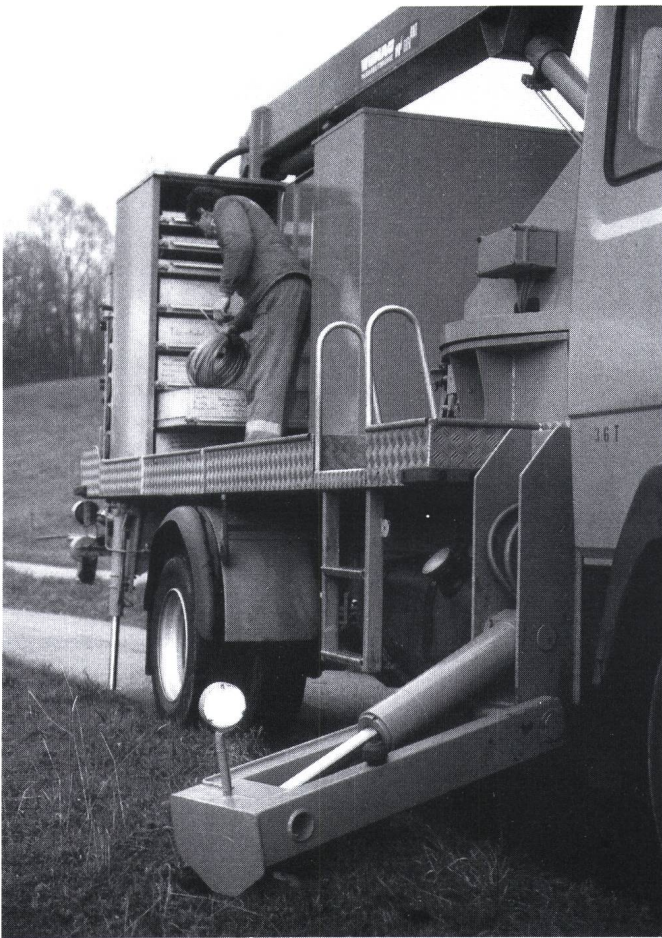
Figur 4 Mercedes-Lastwagen mit hydraulischen Stützen und Werkzeugkästen
