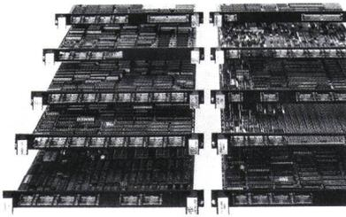
**MaxVideo von Datacube: eine Familie von 24 VME-Boards, aus denen MIMD-Rechner höchster Leistungsfähigkeit für die Bildverarbeitung konfiguriert werden können.**
