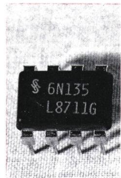
schnelle Datenübertragung von 1 MBit/s und eine Bandbreite von 2 MHz aus. Die Isolationsprüfungstransspannung beträgt 2500 V (3535 V DC); höhere Werte sind auf Anfrage erhältlich. Ein weiteres Merkmal ist das Stromübertragungsverhältnis CTR von typ. 16 Prozent beim 6N135 und von typ. 35 Prozent beim 6N136.
