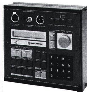
worden: Neutrik Analyser 3337. Dieses Messgerät verfügt über eine hohe Genauigkeit bei einfachster Bedienung. Der vollautomatisch arbeitende Analyser erlaubt rasche und genaue Messungen von Pegel, Frequenz, Klirrfaktor ( $k_2 \dots k_5$ , THD+N, DFD, IMD), Pegelverhältnis, Verstärkung im Frequenzbereich 20 Hz-40 Hz.
