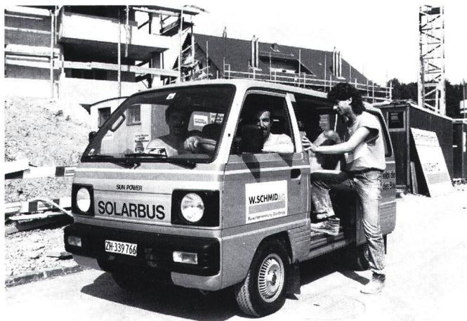
Die Solaranlage dient über das Netz auch zum Aufladen eines Elektro-Personalbusses, einer Eigenkonstruktion, die 4 bis 6 Personen aufnehmen kann und eine Reichweite von 50 bis 100 km hat.
