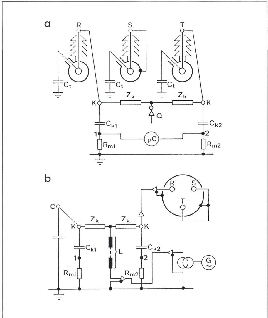
**Figur 2 Doppel-Straight-Schaltung mit Hocheinspeisung durch Resonanz-Stromquellen, Beispiele für TE-Messung an SF<sub>6</sub>-Anlagen**
