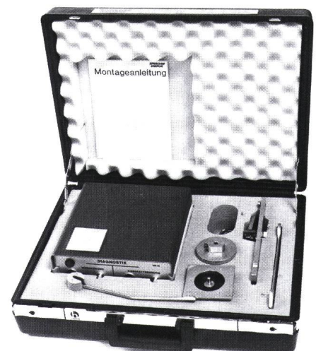
Figur 7 Beispiel eines Diagnostik-Sets für die Kontrolle des Kontaktzustandes, ohne den Leistungsschalterpol öffnen zu müssen
