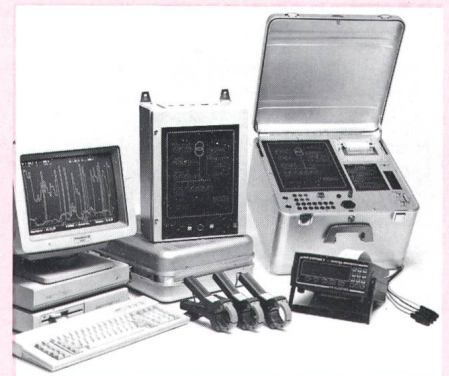
Datenerfassungssystem für NS-Verteilanlagen
