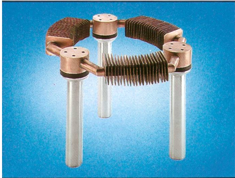
GENERATOREN Wassergekühltes Kontaktelement für den elektrischen und den Kühlwasseranschluss.
