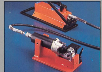
PNEUMATISCHES STANZWERKZEUG zum Stanzen von lamellierten Stromschielen.
