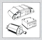
Rotierende Magnet-Bandtrommel: Sie ist am ganzen Umfang magnetisch und wird als Antriebs- oder Umlenktrommel eines Förderbandes verwendet. Das im Fördergut enthaltene Eisen wird von ihr auf dem Förderband festgehalten, bis es auf der Unterseite durch das zurücklaufende Band wieder ausgetragen wird und in einen Behälter fällt.
