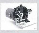
Das neue 3-Komponenten-Werkzeughalter-Dynamometer dagegen ermöglicht die Montage an der Revolverscheibe anstelle eines Werkzeughalters. Das kompakte Dynamometer setzt sich aus drei Teilen zusammen: Einem auswechselbaren Revolveradapter für die Montage des Dynamometers auf ein vorhandenes Spannsystem nach VDI. Andere Spannsysteme können auf Wunsch hergestellt werden.
