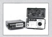
ableiter- und Antennenbau, bei der Errichtung von Tankanlagen sowie für einfache geophysikalische Messungen oder zur Messung der Widerstände fester und flüssiger Leiter stellt die Firma Gossen (D) zwei neue Erdungsmessgeräte vor: Geohm 2 und Geohm 3.
