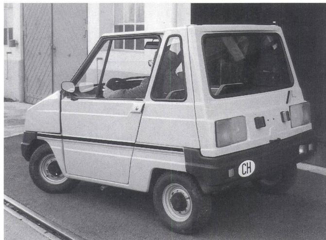
**Neu:** Der bereits typengeprüfte Pinguin 4 der Fridez Solar AG, mit einem 7-kW-Gleichstrommotor, Frontantrieb, Höchstgeschwindigkeit 60 km/h, Leergewicht 650 kg (davon 340 kg Batterien!), Zuladung 200 kg
