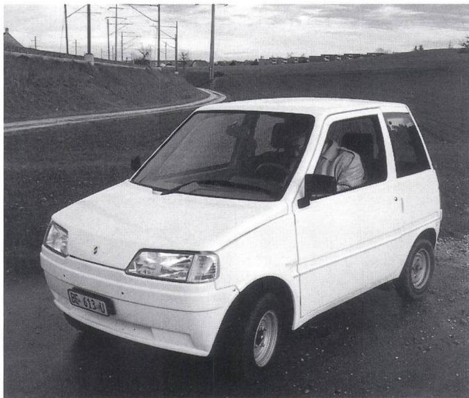
**Neu:** Der 2,5 m kurze Solec RIVA, je nach Ausführung mit einem 2,5 bzw. 3,3-kW-Gleichstrommotor pro Vorderrad, Höchstgeschwindigkeit ca. 50 bzw. 60 km/h, Leergewicht 520 kg (davon ca. 200 kg Batterien), Zuladung 200 kg
