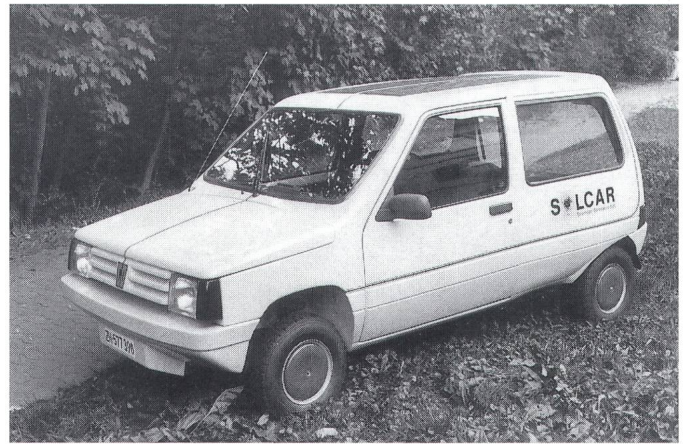
Neue Serie: Der Solcar 1 der Solarmobilgenossenschaft Filzbach für zwei Erwachsene und zwei Kinder oder zwei Erwachsene und 1400 Liter Stauraum, 9-kW-Asynchronantrieb auf die Vorderräder, Höchstgeschwindigkeit 70 km/h, Leergewicht 610 kg (davon ca. 1/3 Batterien), Zuladung 250 kg
