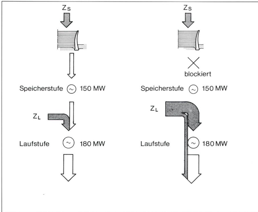
**Bild 6** Schema einer zweistufigen Kraftwerksanlage (Beispiel: KVR)
