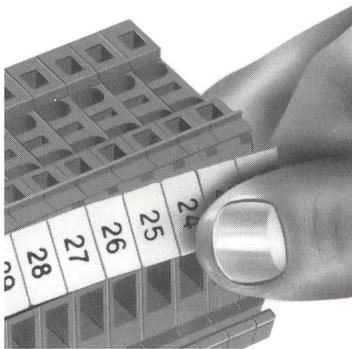
Woertz-Bezeichnungskarten Typ RB5 und RB6 - zur eindeutigen und dauerhaften Markierung von Klemmen. Die einzelnen Schildchen sind bereits aneinandergereiht und können somit reihenweise in einem Arbeitsgang mit leichtem Daumendruck aufgeschnappt werden. Sie sind aber ebenfalls verwendbar für die Einzelbeschriftung von Klemmen, die nicht im 5- bzw. 6-mm-Raster aufgebaut sind.
