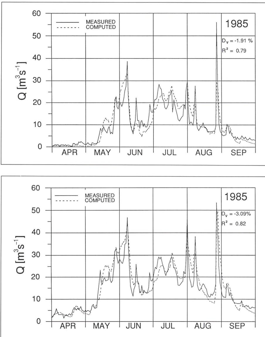
**Bild 4 Berechneter und gemessener Speicherzufluss für zwei Kraftwerksstufen**
