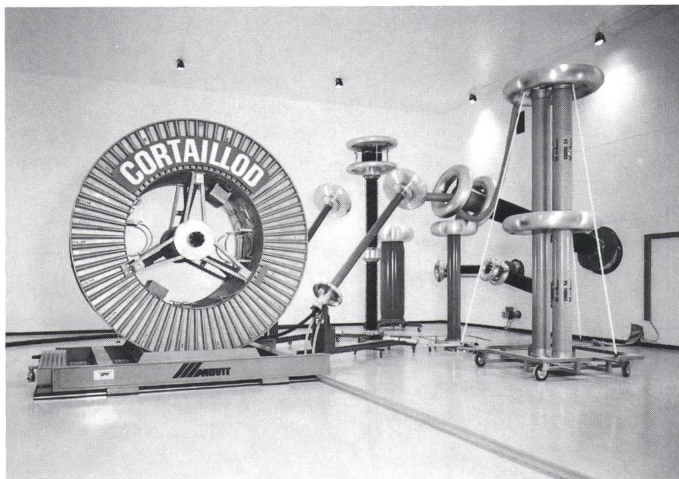
Figure 7 Laboratoire d'essais 480 kV pour câbles à isolation synthétique très haute tension
