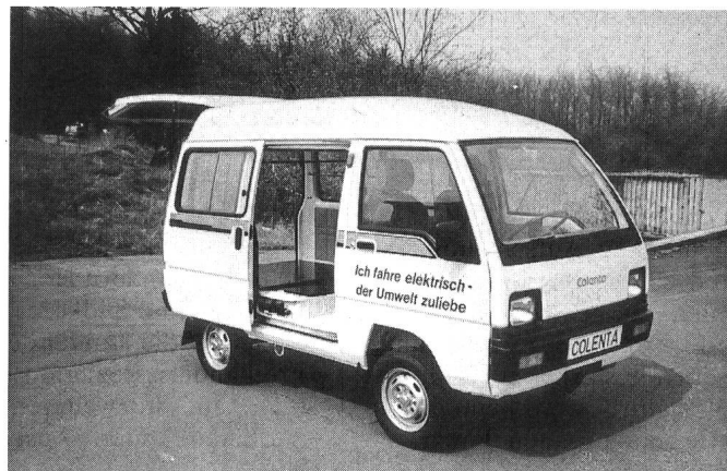
Bild 5 Elektrifizierter Kleinbus und Kleintransporter
