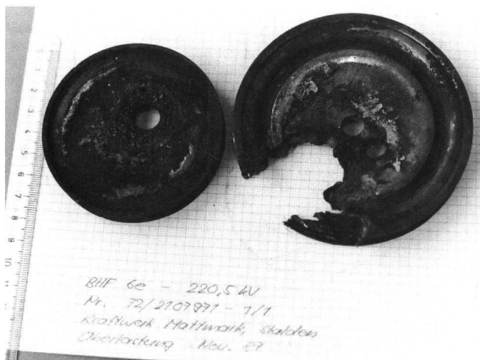
Bild 2 Schadensbild 220-kV-Funkenstrecken- ableiter
