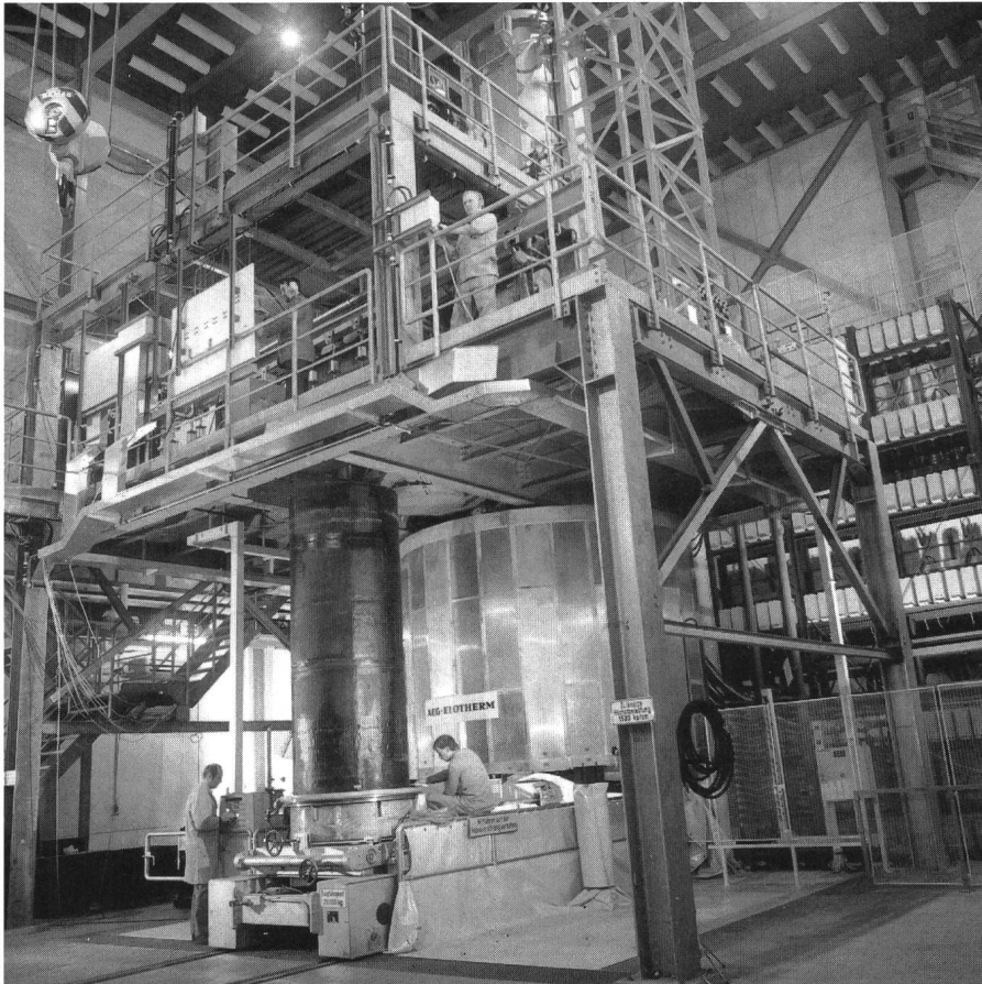
Bild 3 Das Innere von BETA: Im schwarz umhüllten Tiegel (links) «fressen» sich 600 kg einer 2400 °C heissen, nicht radioaktiven Schmelze aus Reaktorstahl bis zu einem Meter tief in Reaktorbeton. Durch die 5 bis 7 Meter starken Betonfundamente deutscher Druckwasserreaktoren würde die Schmelze frühestens nach 4 Tagen bis in den Erdboden vordringen und dort (infolge Kühlung durch das Grundwasser) erstarren.
