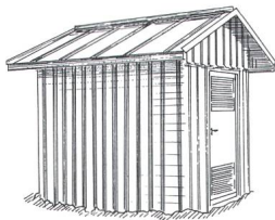
Trafo-Stationen mit Giebeldach
