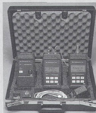
Die Lichtwellen-Leiter-Messeinrichtung im Koffer
