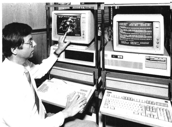
Messausrüstung zur Blitzortung und Blitzparameter-Bestimmung der PTT
