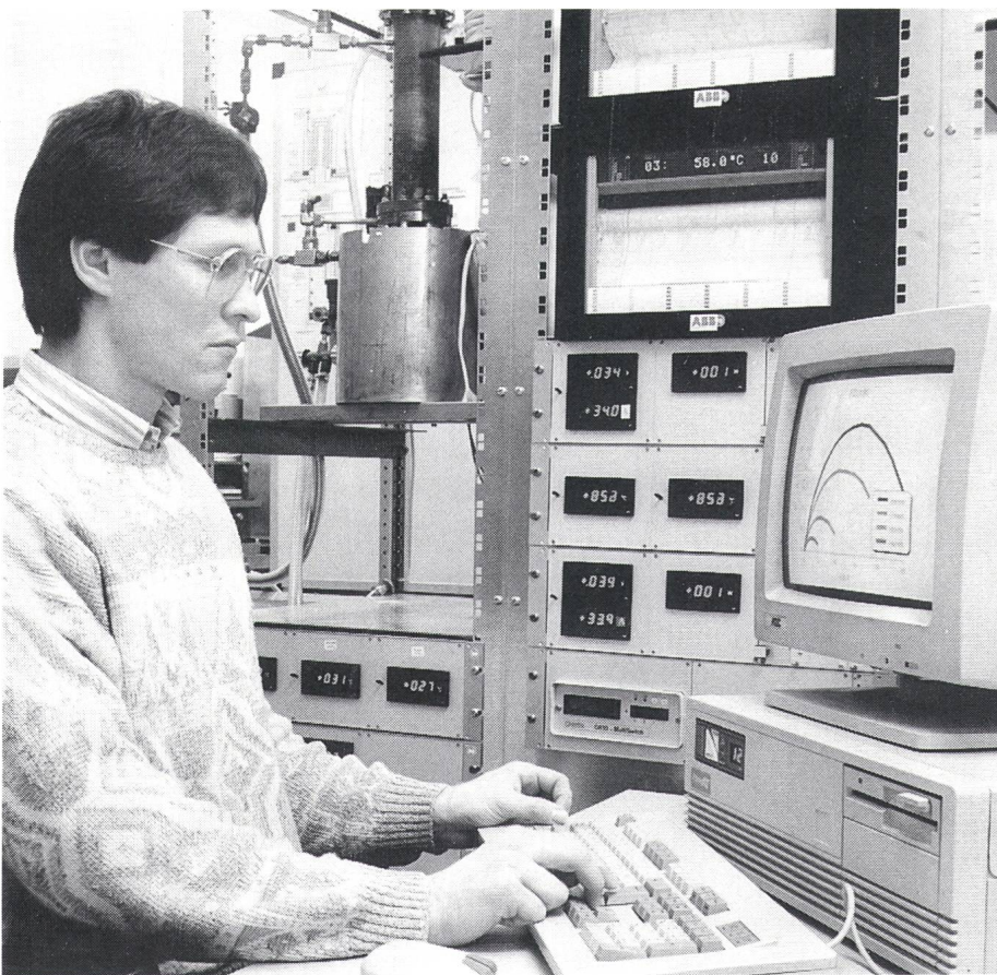
Bild 4 In zahlreichen Messreihen werden die Kennwerte – rechts auf dem Bildschirm Leistung über Stromstärke – von AMTEC-Versuchszellen ermittelt, um Anhaltspunkte für Verbesserungen zu finden
