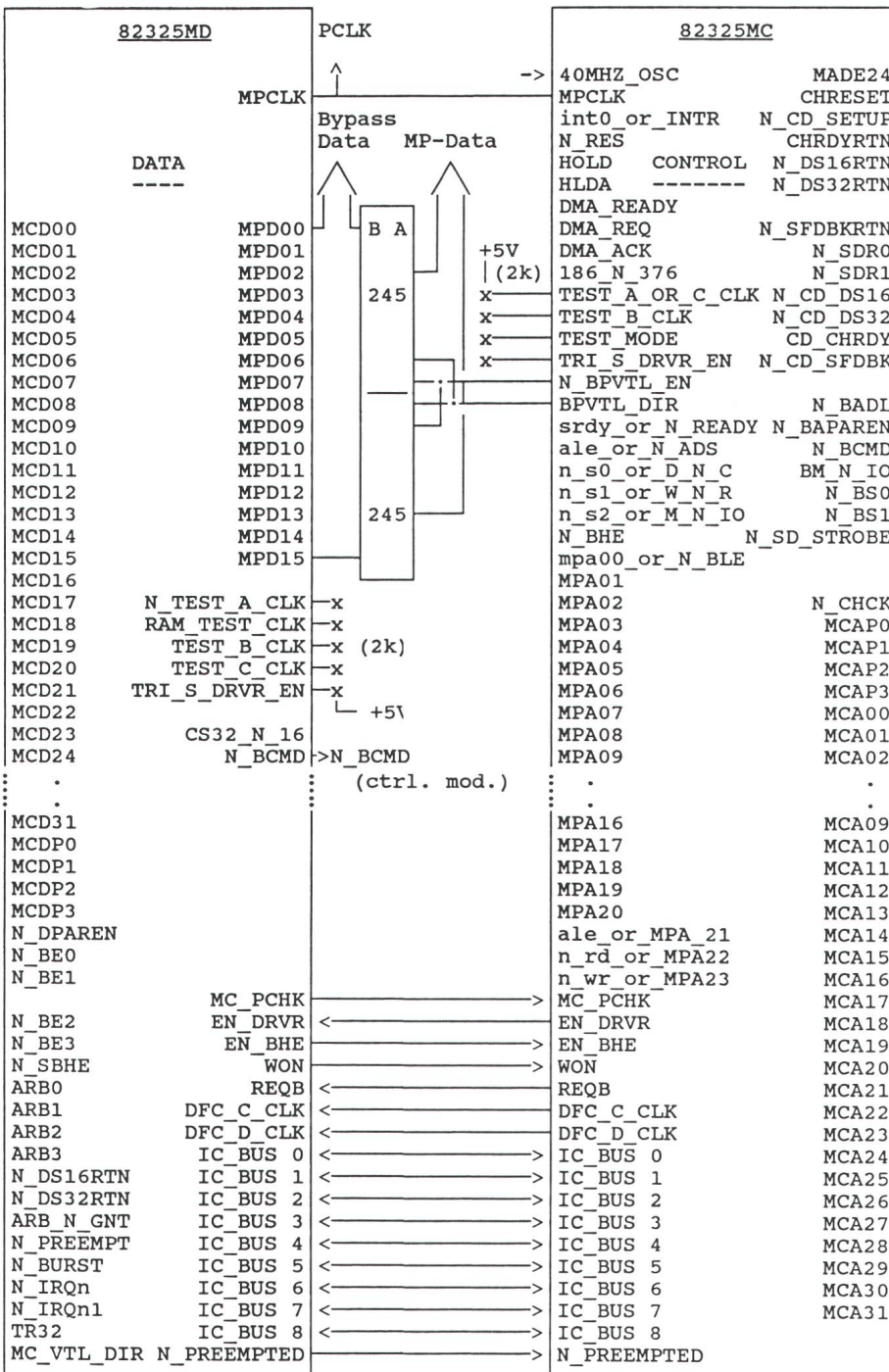
Bild 33a Der Chipsatz 82325 in seiner typischen Schaltungsumgebung
