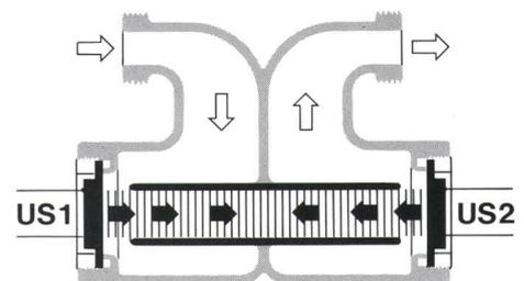
Durchfluß-Messung mit Ultraschallsonden US1 und US2
