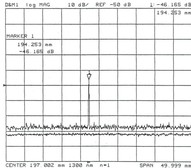
Bild 6 Messung des RL mit einem Michelson-Interferometer
