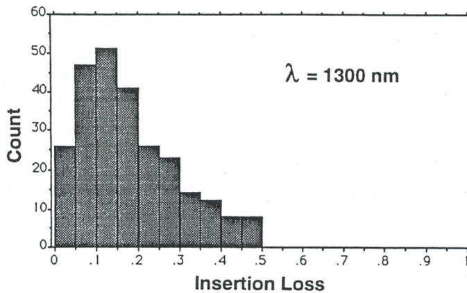
Bild 3 Histogramm von *IL*-Werten eines Steckerloses
