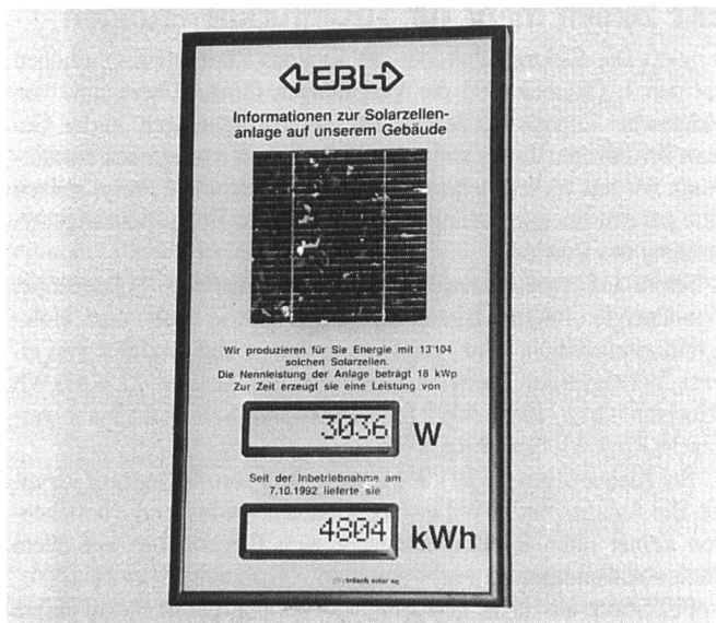
Eine Momentwertanzeige beim Empfang informiert Kunden sowie Mitarbeiter über die momentane Leistung und die seit der Inbetriebnahme der Anlage erzeugte Stromleistung
