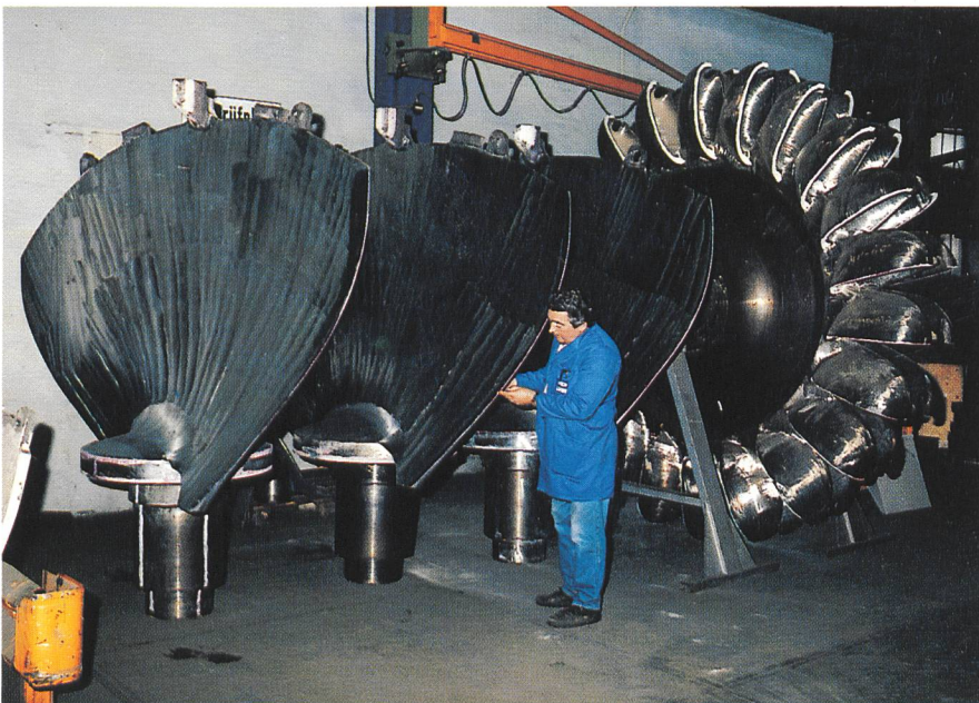
Kaplanflügel und Peltonlaufrad, Stückgewichte max. 25.000 kg.
