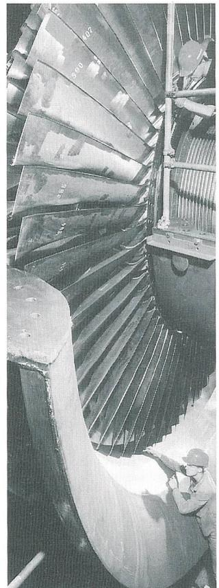
Niederdruck-Dampfturbinen-Laufrad wie für das KKW Isar 2 vorgesehen
